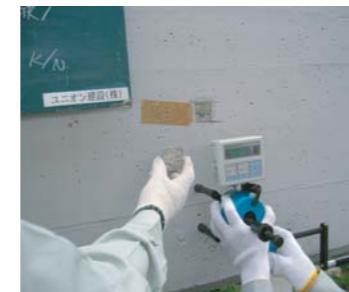
剥離試験:すべて軸体剥離
