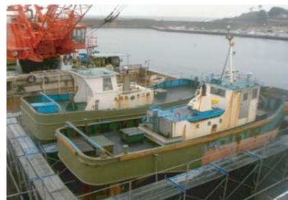
台船の上に固定され塗装工事中の着荷船
